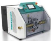
**Машины Metzner серии CT 4000 для мерной резки гофрокондуктивных компонентов**
